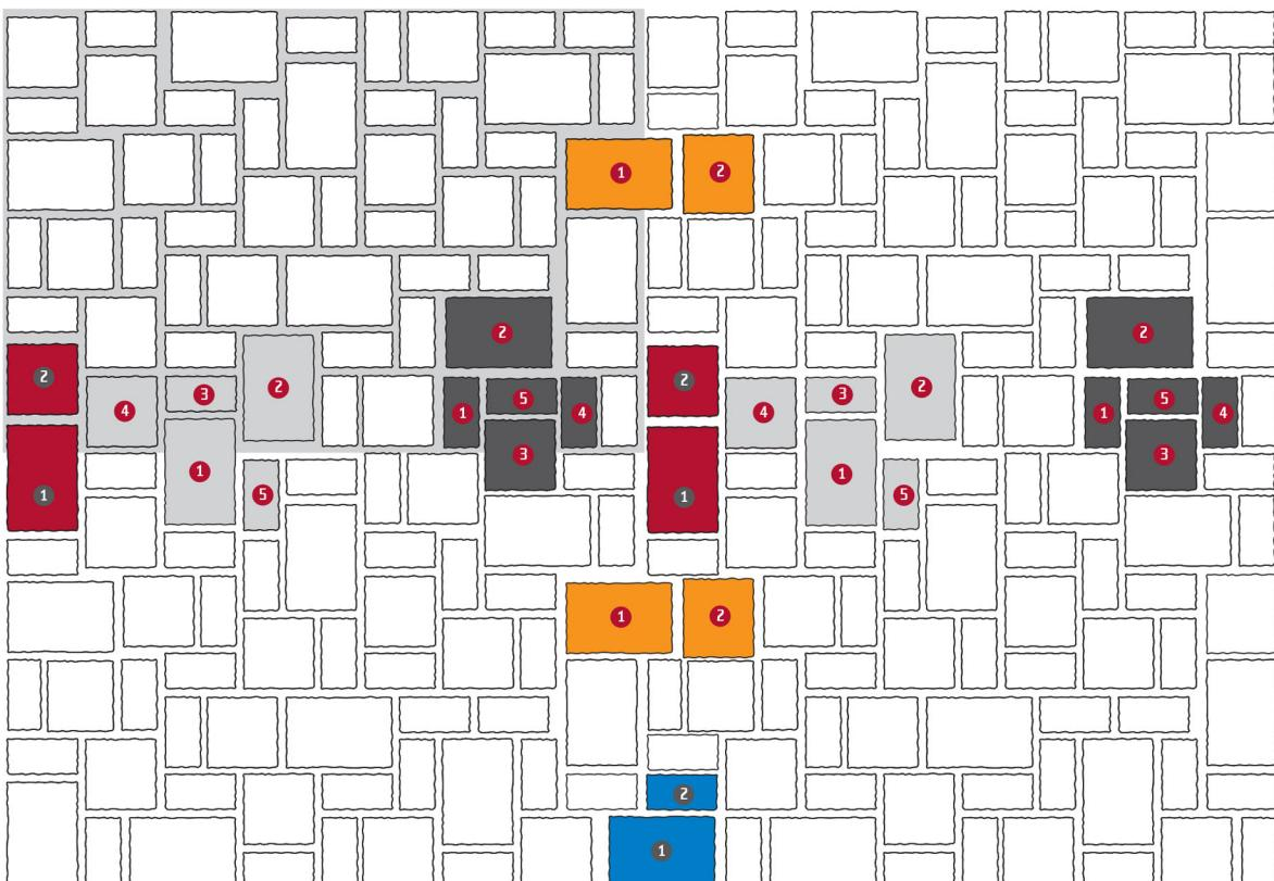
Dlažbu při pokládce pokládejte tak, jak je uložena na paletách. Jakmile dlažbu položíte, zaměňte kameny podle obrázků tak, aby nezůstaly souvislé spáry delší než 70 cm. Dlažební kostky odebírejte z více palet současně, tím předejdete barevným rozdílům zadlážděných ploch.
